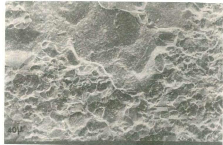
Fig. 4 - Ataque generalizado de uma amostra mantida a -70 mV (ESC) em 1 M HCl. O ataque é mais profundo na zona superior da fotografia, produzindo uma cavidade que à vista desarmada tinha o aspecto de uma picada larga e pouco profunda.
