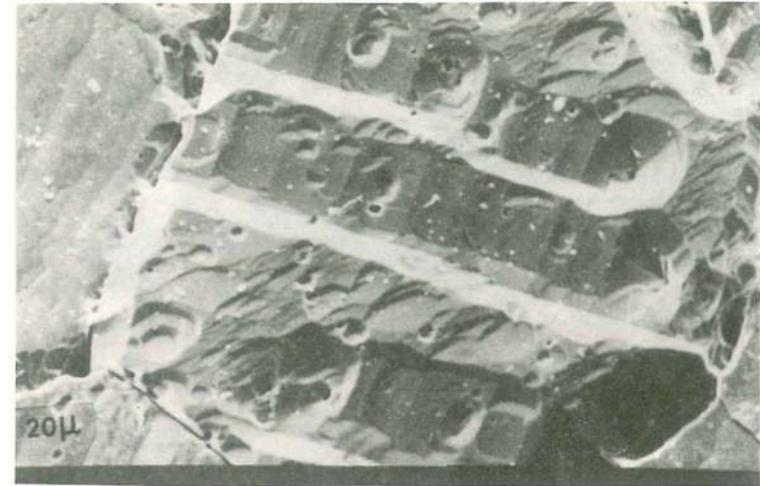
Fig. 3 - Ataque generalizado de uma amostra mantida a -200 mV (ESC) em 1 M HCl. Ataque mais intenso das juntas de grão e de maclas.
