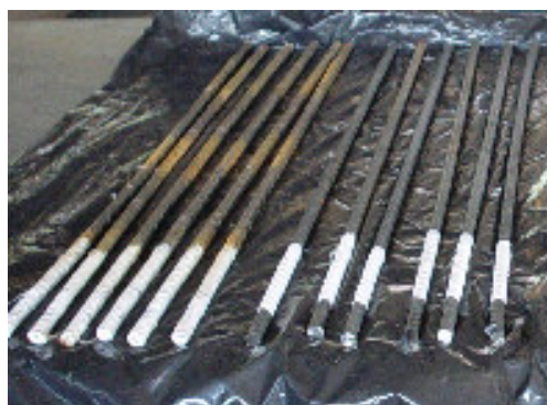
Figura 4. Encintado de secciones del acero de refuerzo.
