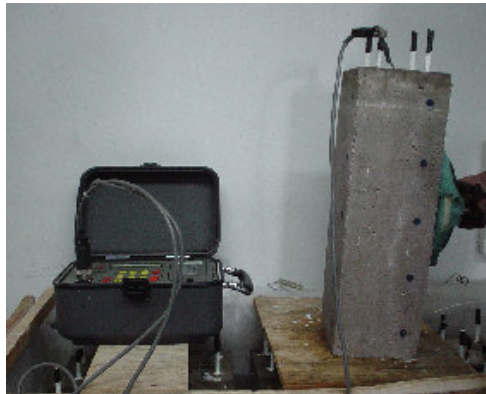
Figura 8. Equipo de corrosión Gecor 6 y sensores de corrosión.
