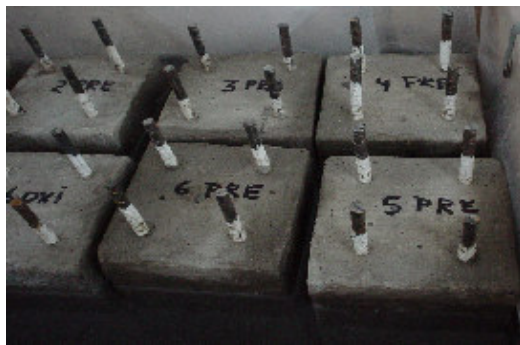
Figura 6. Vigas expuestas a ambiente salino.
